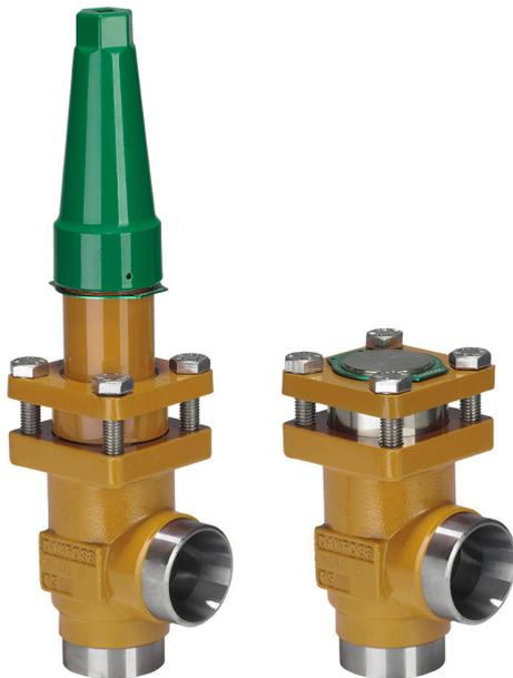
Las válvulas SCA-X son válvulas de retención con una función de válvula de cierre incorporada. Las válvulas CHV-X son solo de retención. Las válvulas SCA-X/CHV-X están disponibles en versiones con paso en ángulo y con paso recto. Estas válvulas están diseñadas para abrirse a presiones diferenciales muy bajas, proporcionan condiciones de flujo favorables y son fáciles de desmontar, lo que facilita su inspección y mantenimiento.
