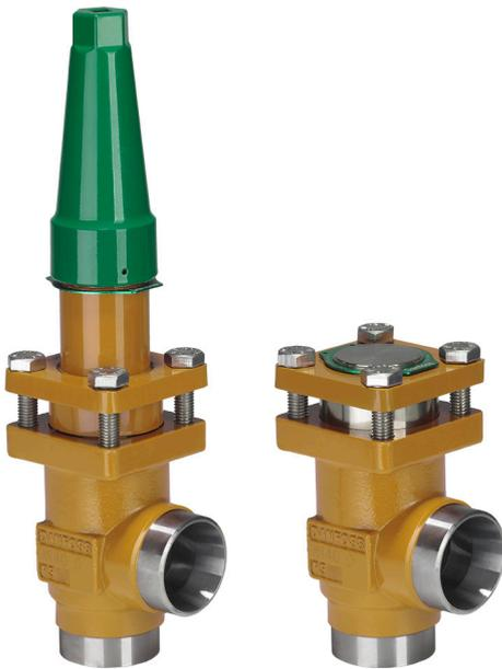
Les SCA-X sont des vannes d'arrêt à fonction anti-retour intégrée. Les CHV-X sont des clapets anti-retour simples. SCA-X/ CHV-X sont disponibles en versions à passage équerre et droite. Ils s'ouvrent à des pressions différentielles très faibles, créant ainsi des conditions d'écoulement favorables. Ils sont faciles à démonter en cas d'inspection et de maintenance.
