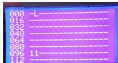
De twee 1-cijfers staan respectievelijk voor de adressen 96 (HP-module) en 97 (Vloeistofvatmodule).
