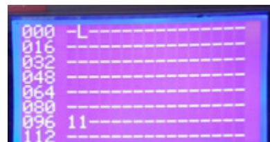
Los dos dígitos 1 representan las direcciones 96 (módulo HP) y 97 (módulo receptor), respectivamente.
