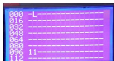
Les deux chiffres représentent respectivement les adresses 96 (module HP) et 97 (module réservoir).
