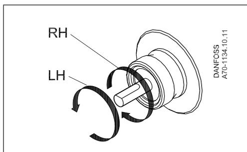
Hinweis! Die Wellendrehung, die Positionen des Düsenausgangs und anderer Anschlüsse sind vom Wellenende aus dargestellt.
