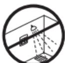
Не следует устанавливать терморегулятор в помещениях с повышенной влажностью. Терморегулятор должен быть установлен вне зоны 2. Разместите его в соседнем помещении и используйте только датчик пола. При установке терморегулятора соблюдайте местные нормы по IP-классам защиты.
