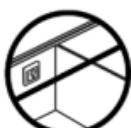
Не размещайте терморегулятор на внутренней стороне наружной стены с плохой теплоизоляцией.
