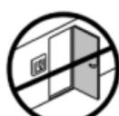
Всегда размещайте терморегулятор на расстоянии не менее 50 см от окон и дверей (из-за сквозняков) при использовании режимов регулирования температуры внутри помещения
