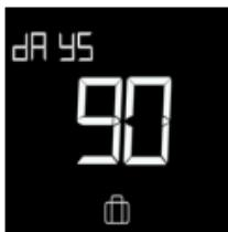
Нажмите кнопку **M**, пока не появится значок . Нажмите кнопку таймера и удерживайте в течение 2 секунд, чтобы с помощью кнопок Вверх / Вниз выбрать количество дней в отъезде (от 0 до 99). Изначально установлено «0» дней. Это значение можно увеличить, нажав кнопку Вверх .
