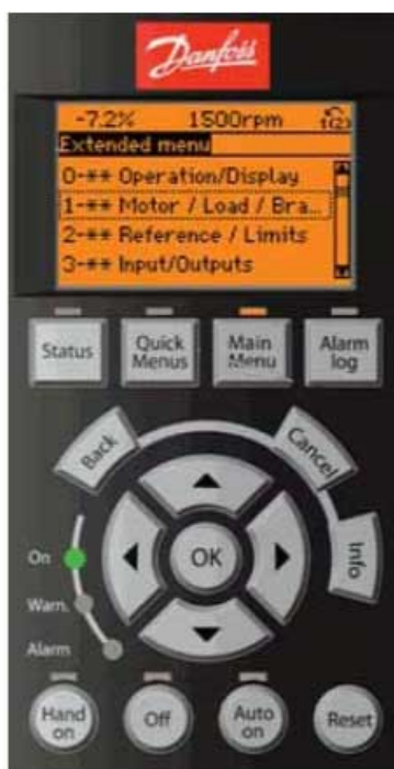
Illustrazione 22: Display grafico LCP (codice dell'ordine 132B1107)
