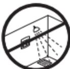
El termostato no debe instalarse en zonas húmedas directas (zonas 0, 1 y 2). Siga siempre la normativa local relativa a las clases IP; esto no significa que los termostatos no se puedan instalar en baños.
