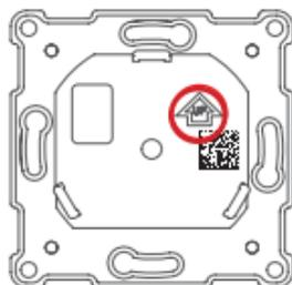
10. Fije el bastidor y el bastidor superior al termostato. A continuación, conecte el termostato a la unidad de suministro eléctrico presionando suavemente hasta que todas las piezas estén firmemente conectadas.
