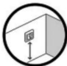
Instale el termostato a más de 50 cm de las aberturas para ventanas y puertas.
