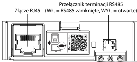
Ilustracja 4: Złącze RJ45 i mikroprzełącznik zamykający obwód RS485
