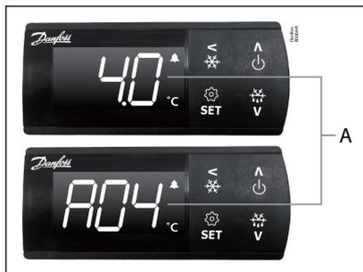
**A** La température et les codes d'alarme clignotent en alternance jusqu'à ce que l'alarme soit résolue. La cloche d'alarme clignote pendant la condition d'alarme.
