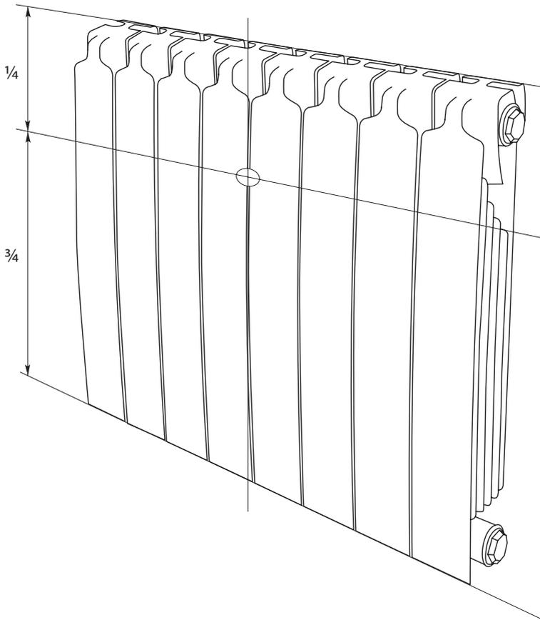
2. При нечетном количестве секций монтаж теплового адаптера производится между средней и соседней с ней секцией радиатора со стороны подводки.
