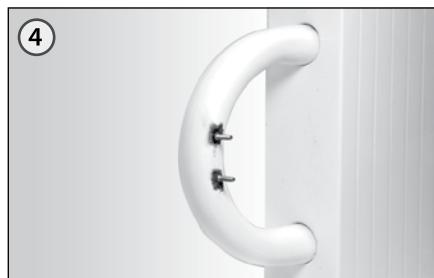
Установить на сварочном пистолете ACCU-TWIN расстояние между захватами 25 мм. Следуя инструкции к пистолету ACCU-TWIN, приварить шпильки M3 к калачу конвектора «Аккорд».
