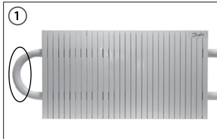
Место монтажа теплового адаптера для счетчика-распределителя тепла INDIV-X-10(R) располагается на калаче конвектора «Аккорд».
