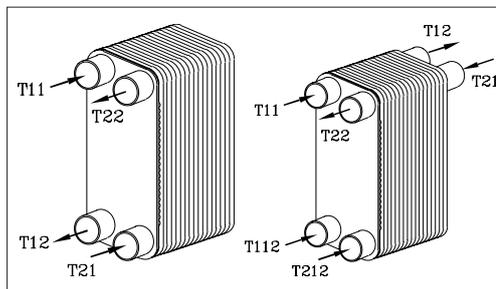
Les échangeurs de chaleur à deux passes de Danfoss sont conçus avec 6 raccords, car ils sont principalement utilisés pour l'eau chaude sanitaire.
