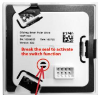
Existe una opción de «solo ambiente», pero requiere la rotura del pequeño sello de plástico y del sello de la placa de circuito impreso a continuación, en la parte posterior del módulo de la pantalla, por ejemplo, con un destornillador; es necesario un restablecimiento;
