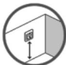
Coloque el termostato a una altura adecuada en la pared (entre 80 y 170 cm). El interruptor se puede colocar en una área libre de la pared.
