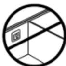
No coloque el termostato en la parte interior de un muro exterior que esté mal aislado.
