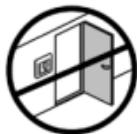
Debido a las corrientes de aire, instale siempre el termostato como mínimo a 50 cm de las ventanas y las puertas cuando use la regulación en: modo de suelo o ambiente o solo modo ambiente.
