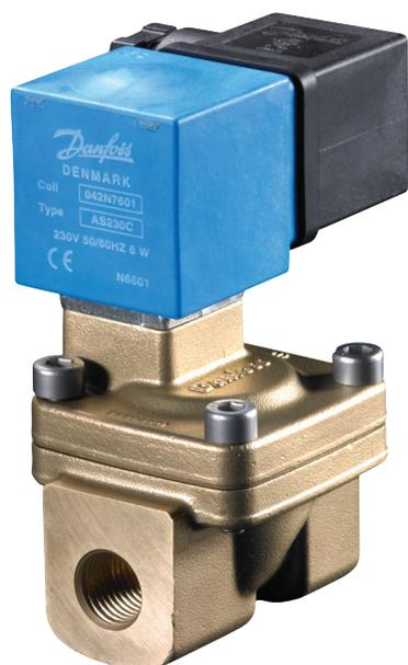
La EV220W è una di elettrovalvola a servoazionamento indiretto a 2/2 vie con attacchi da 3/8" a 2", progettata per l'uso industriale in spazi in applicazioni industriali in cui esistono problemi di ingombro.
