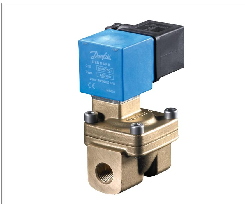
La EV220W è una di elettrovalvola a servoazionamento indiretto a 2/2 vie con attacchi da 3/8" a 2", progettata per l'uso industriale in spazi in applicazioni industriali in cui esistono problemi di ingombro.
