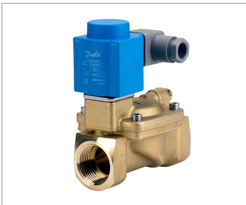
La gama EV220B 15 – EV220B 50 se compone de válvulas solenoide universales, servoaccionadas e indirectas de 2/2 vías. Todas ellas están disponibles con cuerpo de latón, latón resistente a la desgalvanización (latón DZR) y acero inoxidable, lo cual garantiza su validez para un amplio abanico de aplicaciones.
