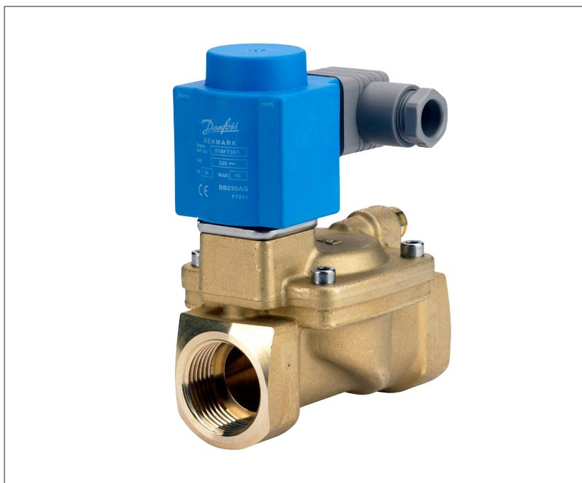
L'EV220B 15 – EV220B 50 è una serie di elettrovalvole a servoazionamento indiretto a 2/2 vie. Corpo valvola in ottone, ottone resistente alla corrosione e acciaio inossidabile garantiscono la copertura di un'ampia gamma di applicazioni. Il filtro incorporato di serie, tempo di chiusura regolabile e protezione fino a IP67 assicurano prestazioni ottimali anche in condizioni di lavoro critiche.
