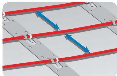
$$\text{Шаг укладки [см]} = \frac{\text{Площадь [м}^2\text{]}}{\text{Длина кабеля [м]}} \times 100 \text{ см}$$
