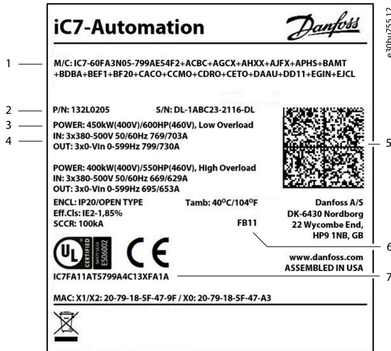
Abbildung 1: Beispiel für den Typencode auf dem Typenschild
