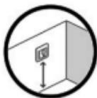
Встановіть терморегулятор на стіні на зручній Вам висоті (зазвичай 80–170 см).
