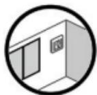
No coloque el sensor de suelo cerca de las aberturas de las puertas ni en lugares donde haya luz solar u otras fuentes de calor en el suelo.
