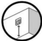
Instale el termostato a una altura adecuada en la pared (entre 80 y 170 cm)
