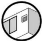
Ne placez pas la sonde de dalle à proximité d'ouvertures de porte ou à des endroits où la lumière du soleil ou d'autres sources de chaleur se trouvent dans le sol.
