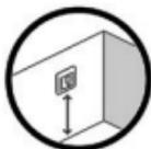
Placez le thermostat à une hauteur adaptée sur le mur (généralement 80-170 cm).
