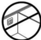
Non collocare il termostato sul lato interno di una parete esterna priva di isolamento adeguato.
