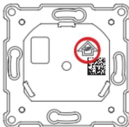
10. Fissare la placca e la placchetta superiore al termostato. Quindi fissare il termostato all'unità di alimentazione premendo delicatamente finché tutte le parti non sono collegate saldamente.
