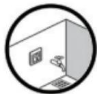
Il termostato non deve essere installato in zone con umidità diretta (Zone 0, 1 e 2). Seguire sempre le norme locali relative alle classi IP; ciò non significa che i termostati non possano essere installati nei bagni.
