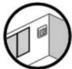
Non posizionare il sensore di superficie vicino alle aperture delle porte o in luoghi esposti alla luce solare o ad altre fonti di calore sul pavimento.
