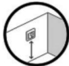
Installare il termostato a un'altezza idonea sulla parete (normalmente 80–170 cm)
