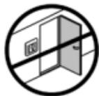
Installare il termostato a una distanza superiore a 50 cm dalle aperture di finestre e porte
