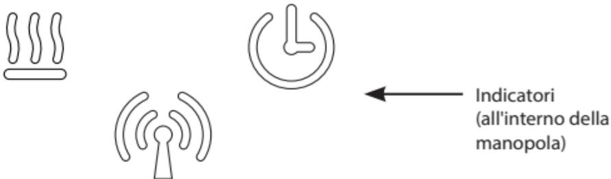
Tutti gli indicatori si spengono dopo qualche istante (durata predefinita 20 secondi) a meno che non sia presente un errore. Inoltre, gli indicatori si attiveranno all'interazione manuale con il termostato, al cambiamento di stato del riscaldamento, all'evento programmato, al collegamento all'app o alla comparsa di errori/avvisi.
