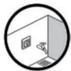
Termostat se ne sme instalirati u direktno vlažnim prostorima (zone 0, 1 i 2). Uvek se pridržavajte lokalnih propisa u vezi sa IP klasama. To ne znači da se termostati ne mogu instalirati u kupatilima.
