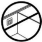
Ne postavljajte termostat na unutrašnju stranu loše izolovanog spoljnog zida.
