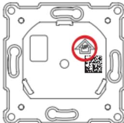
10. Pričvrstite okvir i gornji okvir na termostat. Nakon toga pričvrstite termostat na jedinicu za napajanje blagim pritiskom dok svi delovi ne budu čvrsto povezani.
