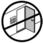
Instalirajte termostat na više od 50 cm od otvora prozora i vrata
