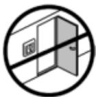
Не встановлюйте терморегулятор в місцях протягів (зазвичай це відстані до 50 см від віконних та дверних отворів)
