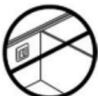
Не встановлюйте терморегулятор на внутрішньому боці зовнішньої стіни з недостатньою теплоізоляцією.
