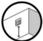
Установіть терморегулятор на стіні на зручній висоті (зазвичай 80–170 см).
