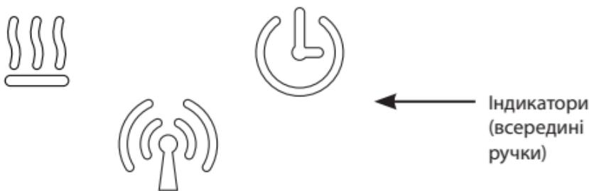
Усі індикатори згасають через певний час (за замовчуванням через 20 секунд), при нормальній роботі терморегулятора. Крім того, індикатори можуть підсвічуватися при ручній взаємодії з терморегулятором, зміні стану нагрівання, події розкладу, з'єднанні із застосунком або виникненні помилок/попереджень.
