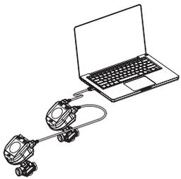
modbus 기능 21(0x15)을 사용하여 NovoCon®에서 펌웨어를 업데이트할 때 파일 크기의 modbus 제한으로 인해 더 작은 섹션으로 업로드를 수행해야 하며, 자세한 내용은 modbus 표준을 참조하시기 바랍니다.
