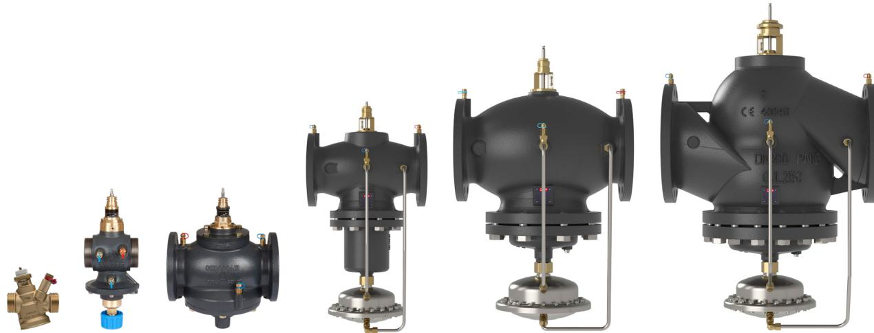
Ventil AB-QM s pogonom je regulacijski ventil s polno avtoritetom in avtomatskim hidravličnim uravnoteženjem in omejevanjem pretoka. Tipični primeri uporabe so: Regulacija temperature in trajno avtomatsko uravnavanje pretoka za končne porabnike (hladilniki zraka, ventilatorski konvektori, induktivne enote, grelne plošče in prenosniki toplote). Brez pogona deluje kot omejevalnik pretoka, npr. za enocevne sisteme.
