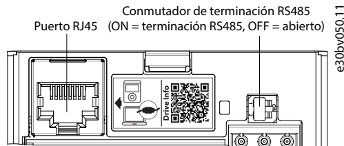
Ilustración 4: Puerto RJ45 y conmutador de terminación RS485
