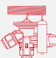
Sustituya el tubo capilar por una válvula TD1 para un control eficaz sobre calentamiento
