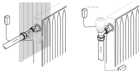
Le bulbe à distance doit être monté sur le mur, à l'écart des rideaux, ou sur la plinthe sous le radiateur si celle-ci ne présente aucune conduite apparente.
