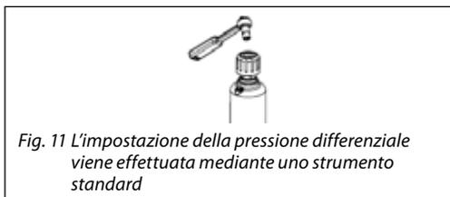
Fig. 11 L'impostazione della pressione differenziale viene effettuata mediante uno strumento standard
