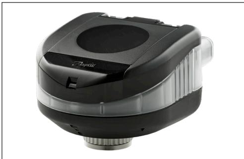
NovoCon® S je vysoce přesný multifunkční sběrnicový pohon určený speciálně pro použití v kombinaci s tlakově nezávislým vyuvažovacím a regulačním ventilem typu AB-QM ve velikostech DN 10–32. Průtok je řízen tlakově nezávislým regulačním ventilem AB-QM tak, aby se zabránilo nadprůtokům a snížení účinnosti zdroje tepla nebo chladu.
