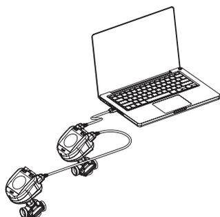
Wenn die Modbus-Funktion 21 (0x15) zum Aktualisieren der Firmware im NovoCon® S verwendet wird, ist es notwendig, das Upload in kleinere Abschnitte zu unterteilen, da im Modbus nur Dateien bis zu einer bestimmten Größe verarbeitet werden können. Weitere Details sind dem Modbus-Standard zu entnehmen.
