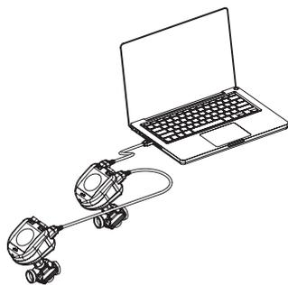
Si se utiliza la función modbus 21 (0x15) para actualizar el firmware en el NovoCon® S, es necesario realizar la carga en secciones más pequeñas debido a las limitaciones de tamaño de archivo de Modbus; consulte el estándar de Modbus para obtener más detalles.
