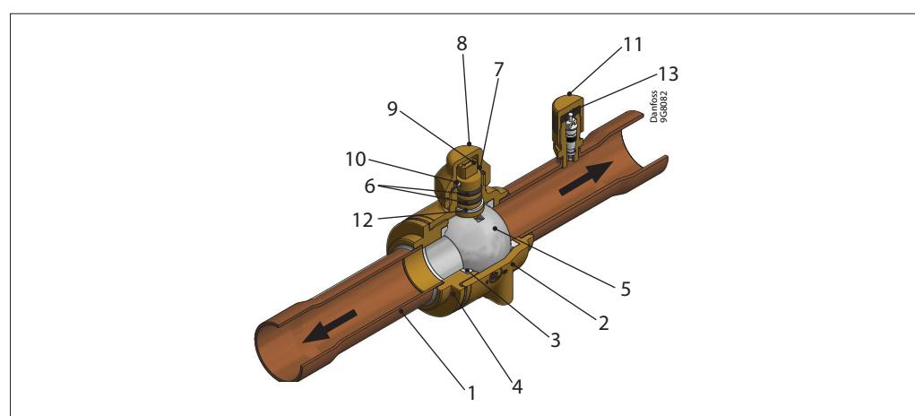
Прямое направление потока обеспечивает максимальную пропускную способность с минимальным перепадом давления на клапане. Сочетание корпуса (2) с лазерными сварными швами, крышки сварного корпуса (4), шарового седла/уплотнения (3), двойного кольцевого уплотнения (6) и уплотнения колпачка (7) обеспечивает превосходную герметичность.
