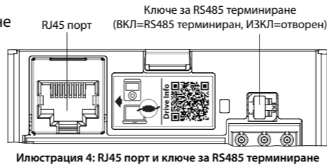
Илюстрация 4: RJ45 порт и ключе за RS485 терминиране
