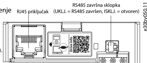
Slika 4: RJ45 priključak i RS485 sklopka za zaključenje
