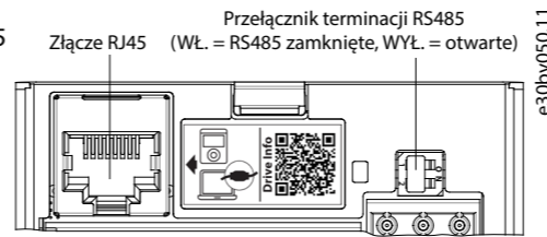
Ilustracja 4: Złącze RJ45 i przełącznik terminacji RS485
