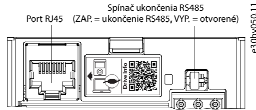
Obrázok 4: Port RJ45 a spínač ukončenia RS485
