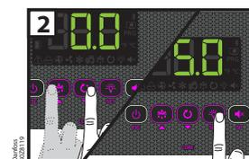
**Importante:** O assistente não será iniciado automaticamente depois de a unidade ter sido energizada pelo menos uma vez. Para iniciar o Assistente a qualquer momento, desligue o controlador pressionando o botão ligar/desligar por 3 segundos e aguarde até que o símbolo de energia fique ligado. Pressione os botões listados aqui em sequência: ▲, ▼ e **SET**.
