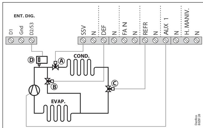
Durante o processo, a válvula solenóide de líquido (C) e a válvula de entrada do condensador são fechadas, e a válvula de entrada do evaporador é aberta, forçando o gás quente a passar através deste último e derretendo o gelo.
