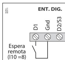
Permite ativar o modo de espera usando um interruptor conectado a uma das entradas digitais. A entrada digital em questão deve ser programada para a ativação remota de espera (**I10=8** ou **I20=12**).
