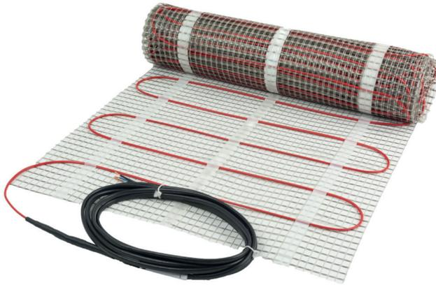
ECmat ist eine extrem hochqualitative Heizmatte. Die Zweileiterheizleitung verfügt über eine 360°-Abschirmung und eine robuste rote PVDF-Außenisolierung. Die robuste Konstruktionsweise und die geringe Aufbauhöhe von 3,5 mm ermöglichen eine schnelle, unkomplizierte und sichere Installation, speziell auch bei der Renovierung bestehender Fußböden.
