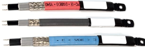
ECpipeguard ist ein selbstlimitierendes Heizband und wird zum Frostschutz von Rohren eingesetzt. Das Heizband passt die Leistung punktuell in Abhängigkeit der Umgebungstemperatur nach oben und unten an. Die Funktion bleibt auch dann erhalten, wenn es gekürzt wird.
