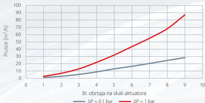
Varijacija u protoku u zavisnosti od \Delta p podešavanja
