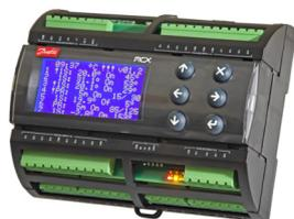
DEVireg™ Multi est un contrôleur programmable électronique à 7 canaux à installer sur rail DIN. Chaque canal peut
