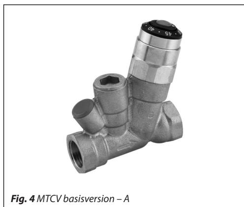
MTCV - er en termostatisk selvirkende, proportional ventil. Et termoelement (fig. 6 elem. 4) er placeret i ventilkeglen (fig. 6 elem. 3) og reagerer på temperaturændringer.
