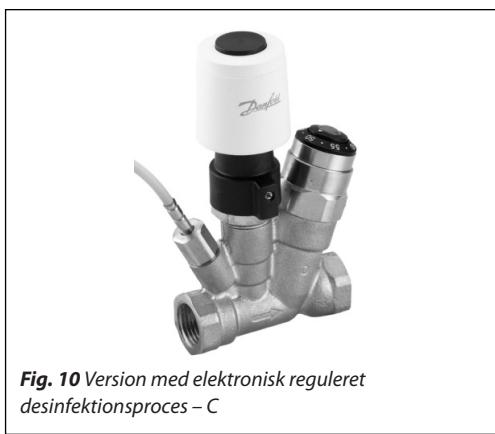
MTCV version "A" og "B" kan opgraderes med en elektronisk reguleret desinfektionsproces (version C). Efter fjernelse af desinfektionsproppen (fig. 6 elem. 13) kan adapteren monteres (fig. 12 elem. 21), og termomotoren TWA kan monteres.
