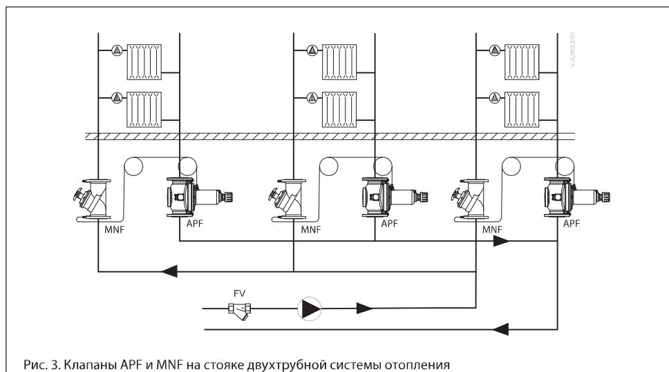
Клапаны APF применяются в системах отопления для регулирования перепада давления в стояках и на горизонтальных ветвях. Для ограничения и расхода через отдельные радиаторы клапаны терmostатических регуляторов должны быть оснащены устройством предварительной настройки, и на стояке должен
