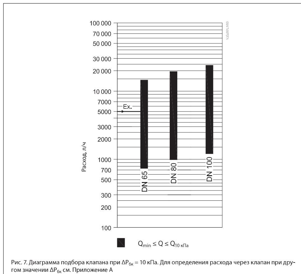
Рис. 7. Диаграмма подбора клапана при  $\Delta P_{6k} = 10 \text{ кПа}$ . Для определения расхода через клапан при другом значении  $\Delta P_{6k}$  см. Приложение А
