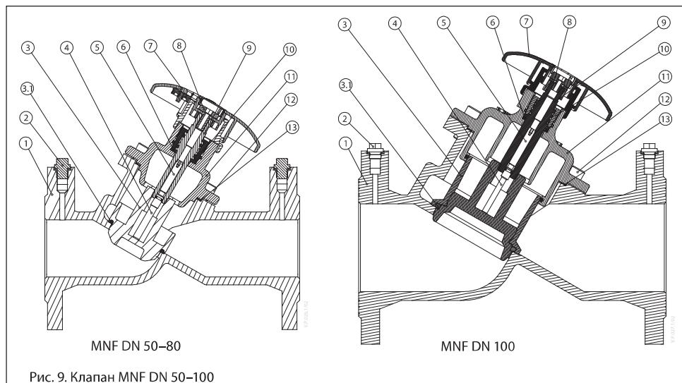
Рис. 9. Клапан MNF DN 50–100
