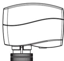
AME 110 und 120 sind hochpräzise modulierende motorische Stellantriebe, die sich für eine präzise Regelung auf das AB-QM montieren lassen. Durch ihre Kalibrierfunktion entspricht der Hub des Stellantriebs immer ganz genau dem Hub des AB-QM. Der Stellantrieb ist sowohl für lineare als auch für logarithmische Charakteristiken geeignet. Der AME 110/120 passt auf das AB-QM in den Nennweiten DN 15 LF bis DN 32 HF.
