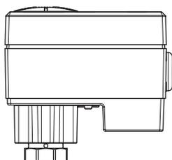
Der AME 13 ist ein präziser motorischer Stellantrieb mit eingebauter Feder, die das Ventil schließt (Spring Down, SD; die Antriebsstange wird ausgefahren) oder das Ventil öffnet (Spring Up, SU; die Antriebsstange wird eingefahren), wenn die Spannung am Stellantrieb unterbrochen wird. Die Charakteristik kann mit einem DIP-Schalter auf logarithmisch oder linear gestellt werden. Der AME 13 SU/SD passt auf das AB-QM in den Nennweiten DN 15 LF bis DN 32 HF.
