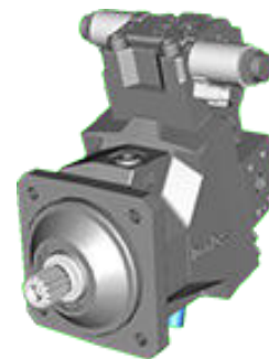
ソレノイド C6 非励磁 = 最小容量 フル励磁 = 最大容量
