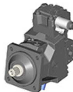
ソレノイド C6 非励磁 = 最大容量 励磁 = 最小容量
