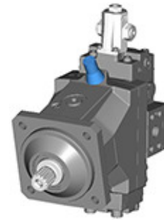
油圧アクチュエータ X1 加圧なし = 最大容量 フル加圧 = 最小容量
