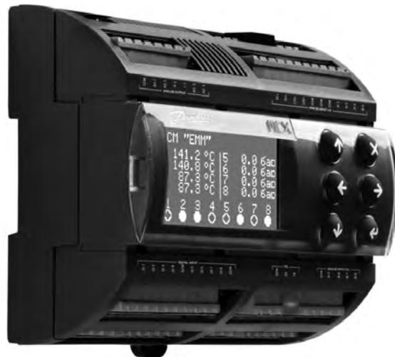
Модуль мониторинга PCM MM PLUS — это микропроцессорный контроллер с предустановленным программным обеспечением, предназначен для построения на его базе систем удаленного мониторинга и автоматизации контроля технологического процесса, водо- и теплоснабжения для тепловых пунктов, систем диспетчерского контроля.
