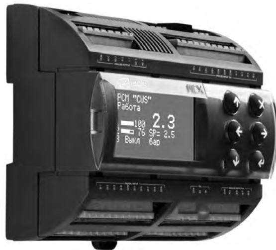
Модуль управления насосами PCM CWS PLUS — это микропроцессорный контроллер с предустановленным программным обеспечением, предназначенный для регулирования давления воды в системах холодного водоснабжения, горячего водоснабжения, отопления и т.д., с каскадным подключением до четырех насосов в одной насосной группе.
