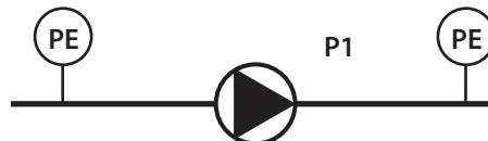
Работа насоса осуществляется по алгоритму поддержания постоянного давления или перепада давлений по двум аналоговым датчикам. Для анализа перепада давления и выявления неисправности насоса предусмотрены два аналоговых датчика. Для защиты насосов по «сухому» ходу также используется аналоговый датчик давления на всасе.
